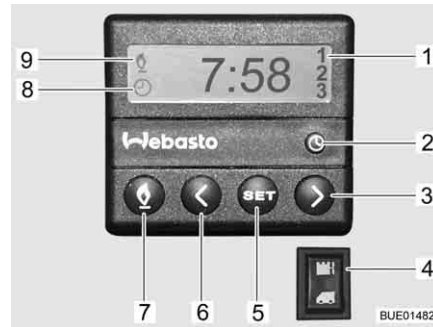
Fig. 195 Centralina di controllo per riscaldamento fisso
