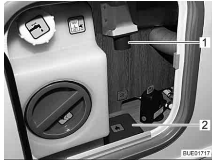
Fig. 157 Collegamento a 230 V al veicolo (con unità di alimentazione centrale)
