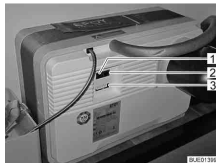
Fig. 152 Campo di collegamento pila a combustibile
