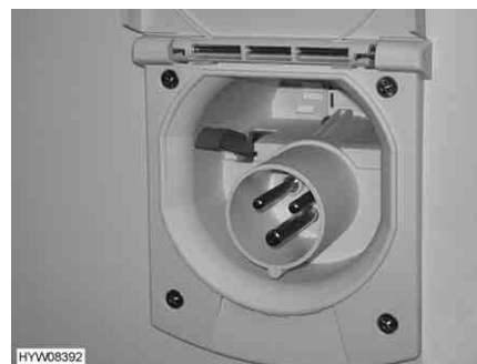
Fig. 168 Collegamento a 230 V sul veicolo
