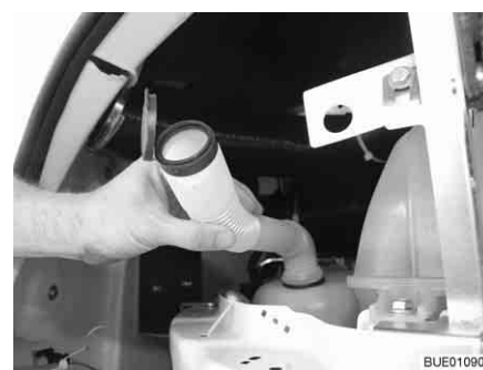
Fig. 45 Bocchettone di riempimento in posizione di riempimento
