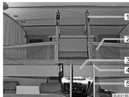
Fig. 132 Letto basculante con rete protettiva montata
