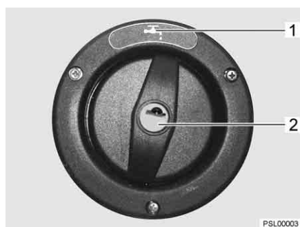
Fig. 229 Bocchettone di riempimento dell'acqua potabile (Lyseo I)
