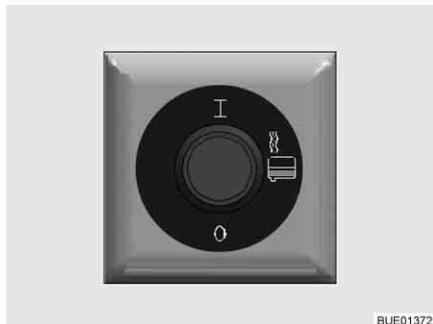
Fig. 245 Interruttore per riscaldamento acque grigie
