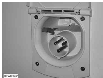
Fig. 174 Collegamento a 230 V sul veicolo
