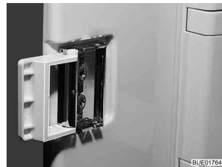
Fig. 228 Dispositivo di chiusura in posizione di ricircolo d'aria
