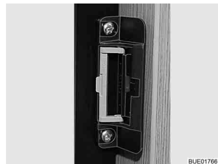
Fig. 225 Dispositivo di chiusura in posizione di ricircolo d'aria
