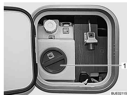
Fig. 261 Apertura per la pulizia sul serbatoio dell'acqua (unità di servizio)
