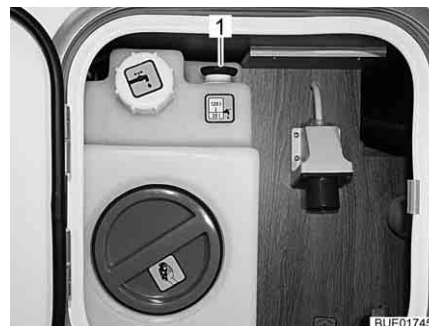
Fig. 238 Serbatoio dell'acqua con maniglia girevole nell'unità di servizio
