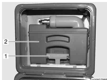
Fig. 258 Serbatoio fecale (esempio)
