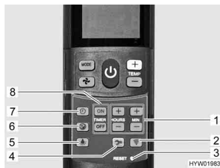
Fig. 209 Telecomando con tasti di impostazione (impianto di climatizzazione)
