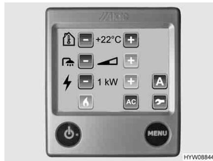
Fig. 196 Menu delle impostazioni (centralina di controllo)
