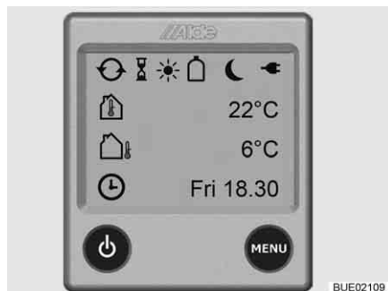
Fig. 195 Schermata iniziale (centralina di controllo)
